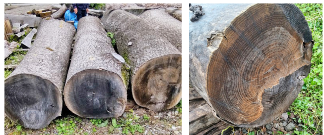
図7 伐採から1-2年ほど寝かせる。日割れを防ぐためシートを被せることもある
