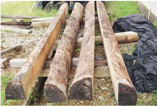
図8 四つ割りにして1-2年乾燥させる。割ることで内部の腐れを防ぐ
