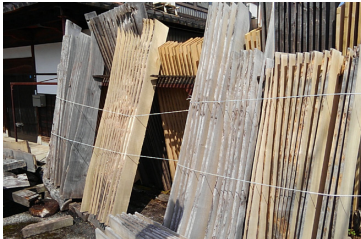
1. 丸太の状態です1年程乾燥させた後、四つ割りにし、半年～1年程天日干しして灰汁抜きする
