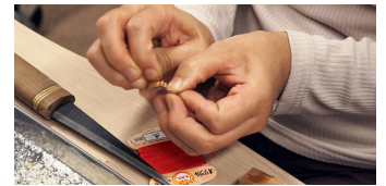
5. 音色や音量を調節するセメと呼ばれる籐の輪を作る
