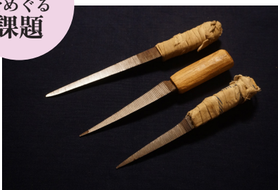
櫛の歯の形を整えるためのガンギリ(ヤスリ的一种) 通常のヤスリとは素材も製法も使い方も異なる。手作業でヤスリを製作する職人がいなくなったため、新品は入手できない。(関田徹也氏提供)
