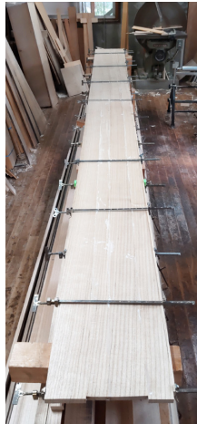
2. 木目を合わせて横に継ぎ足すことで大きな一枚板にできる
