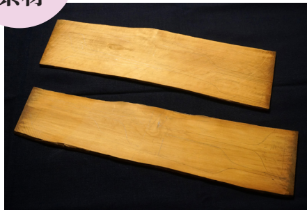
製材したツゲの材 御蔵島から東京の竹芝棧橋に船で届けられたツゲのうち、太く上等な木は櫛職人が、5寸以下のすんなりしたものは印材屋や版木屋が、細く目の込んだものは将棋の駒職人が買いとったという。(関田徹也氏提供)
