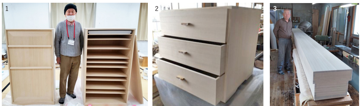
図13 文化財用保存桐箱 1. 修復した古代布を収める慳食箱(けんどんぼこ) 2. 日記などの冊子を収容する3段の引き出し 3. 大きな曼荼羅を入れる5m近い桐箱
