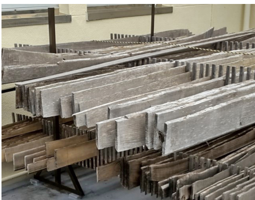
図10 1年以上天日干しする。雨にあたることで桐板内部のアクが表面に抜け出てきて、肌色の木肌がねずみ色に変色する
