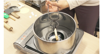
3. 熱したひしぎ鍋で吹き口を潰す
