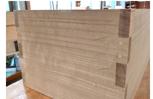
4. 隙間がないよう木釘を効かせて糊で固着させる
