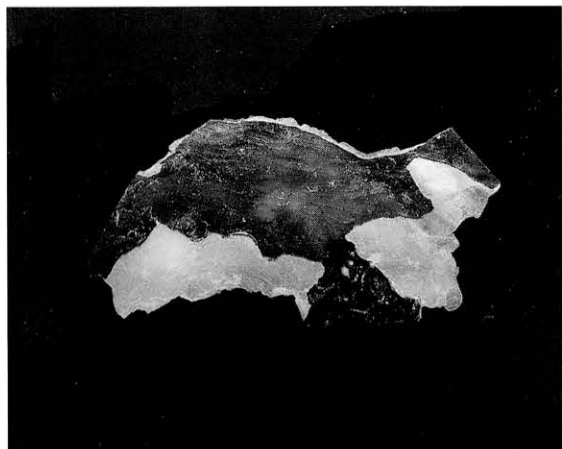
図128 剥離面に付着する褐色のタンパク質 Brown protein on the peeled off surface
