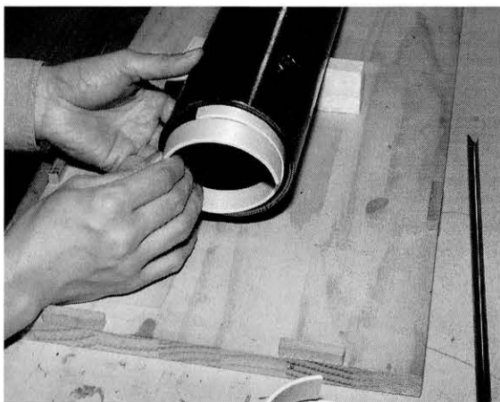
図168 取付作業 Inserting the spiral ring
